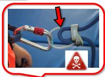
NON corde mal passée dans le système
