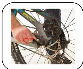
**Contrôle du serrage des roues AV et AR**
